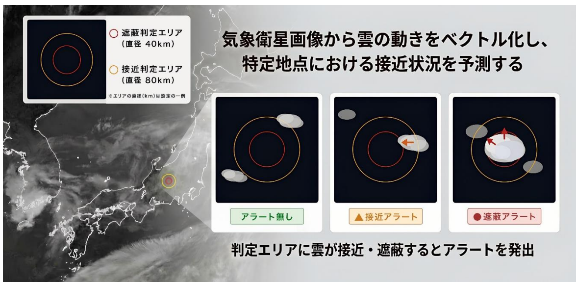
雲移動予測システム「KAZAMI™」解析・予測プロセスのイメージ
